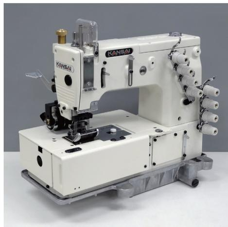
Серия DLR — высокоскоростные многоигольные (3 -4 иглы) машины двухниточного цепного стежка с плоской платформой и поперечным перемещением петлителей. Используются для средних и тяжёлых тканей при выполнении таких операций, как шов " в замок", изготовление пояса джинс и т.д. Уникальный механизм ролика дополнительного продвижения позволяет транспортировать ткани даже при работе на высоких скоростях, формируя при этом идеальные стежки.
