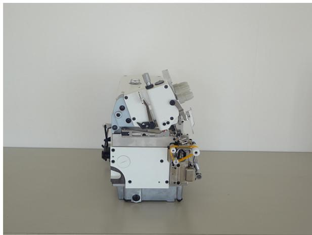
Промышленный 3-х ниточный оверлок Kansai Special JJ-5004GH-WG/DR оснащен цилиндрической платформой. Прекрасно подходит для обработки входа рабочей перчатки.
