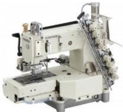
Четырехугольная машина двойного цепного стежка с цилиндрической платформой (диаметр 420 мм) для притачивания резинки, с пуллером, с пневматической обрезкой нити и подъемом лапки.
