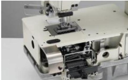
Четырехугольная машина двойного цепного стежка с цилиндрической платформой (диаметр 420 мм) для притачивания резинки, с пуллером, с устройством дозированной подачи.
