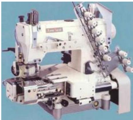
Четырехигольная машина с цилиндрической платформой (диаметр 340 мм) для притачивания резинки, с последовательно расположенными иглами, с механизмом горизонтального хода петлителя, с пневматической обрезкой нити и подъемом лапки, 4 петлителя, 8 нитей.
