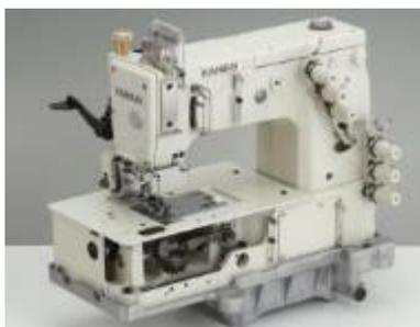
Четырехигольная (шестиигольная) машина двойного цепного стежка с плоской платформой, с задним пуллером для притачивания пояса джинсов.
