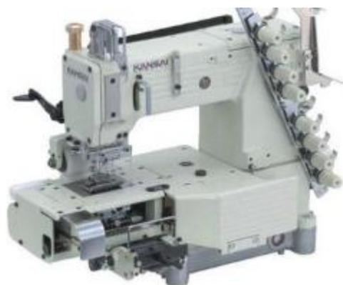
Шестиигольная машина двойного цепного стежка с цилиндрической платформой (диаметр 420 мм) для притачивания резинки, с пуллером.
