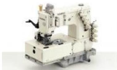
Двенадцатиигольная машина двойного цепного стежка с плоской платформой для выполнения поперечной сборки, с заправкой эластичной резинки в петлитель, с гладким пуллером.
