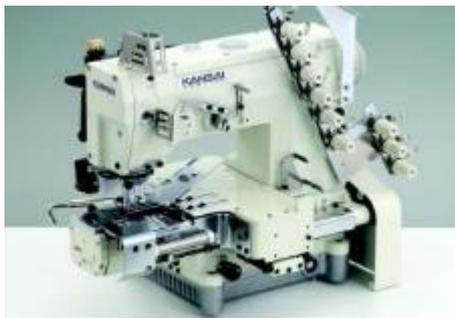
Четырехугольная машина двойного цепного стежка с цилиндрической платформой диаметром 340 мм, для притачивания резинки "в кольцо", 2 петлителя, 6 нитей. Машина широко применяется при обработке поясов на мужском нижнем белье.
