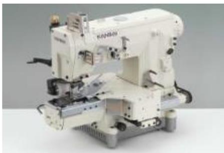
Четырехугольная машина двойного цепного стежка с плоской платформой для настрачивания резинки, с пуллером.
