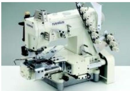
Пятиигольная машина с цилиндрической платформой (диаметр 340 мм) для втачивания резинки в пояс, с последовательно расположенными иглами, с механизмом горизонтального хода петлителя, с пневматической обрезкой нити и подъемом лапки.
