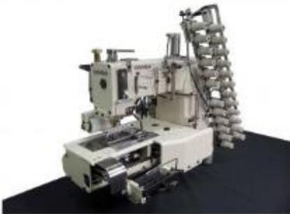
Двенадцатиигольная машина двойного цепного стежка с цилиндрической платформой (диаметр 420 мм) для притачивания резинки, с пуллером, устройством дозированной подачи.
