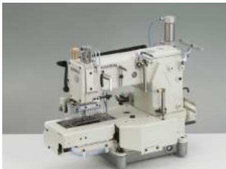
Двенадцатиигольная машина двойного цепного стежка с цилиндрической платформой (диаметр 420 мм) для притачивания резинки, с пуллером, с пневматической обрезкой нити и подъемом лапки.
