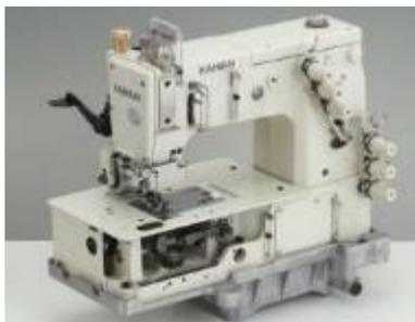
Четырехигольная машина двойного цепного стежка с плоской платформой, с независимым верхним и нижним пуллерами, с регулировкой угла наклона, с возможностью независимой регулировки реек, для изготовления сложных поясов.
