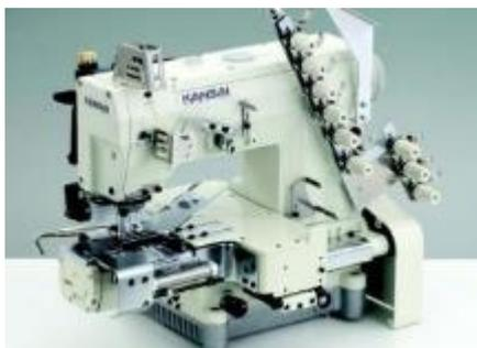
Пятиигольная машина с цилиндрической платформой (диаметр 340 мм) для втачивания резинки в пояс, с последовательно расположенными иглами, с механизмом горизонтального хода петлителя, 4 петлителя, 9 нитей.
