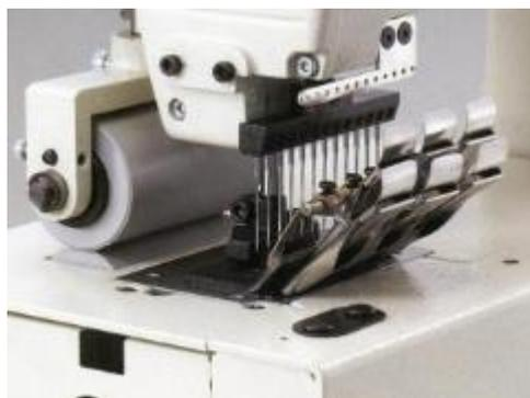
Двенадцатиигольная машина двойного цепного стежка с плоской платформой для выполнения сборки с обшиванием эластичной нитки (резинки), для шитья эластичными нитками, с пуллером.
