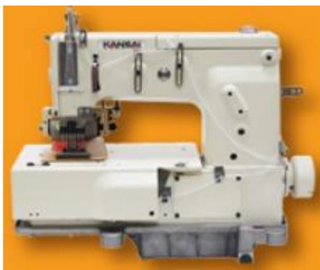
Шестиигольная машина двойного цепного стежка с цилиндрической платформой, с игольным продвижением ткани, с пуллером для обработки пояса джинсов.
