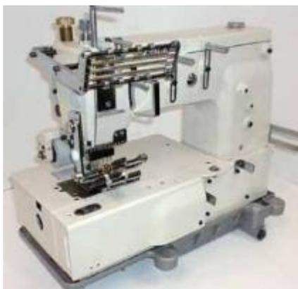
Восьмигольная машина двойного цепного стежка с плоской платформой для настрочивания резинки, с пуллером, с устройством дозированной подачи.
