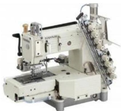
Четырехигольная машина двойного цепного стежка с цилиндрической платформой (диаметр 420 мм) для притачивания резинки, с пуллером.
