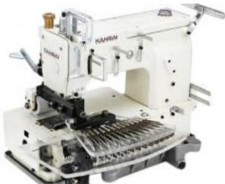
Четырехигольная машина двойного цепного стежка с плоской платформой, с независимым верхним и нижним роликами, для изготовления сложных поясов.
