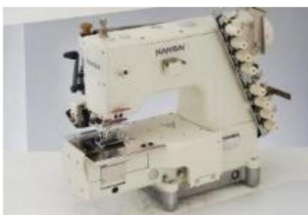
Четырехугольная машина двойного цепного стежка с цилиндрической платформой, с игольным продвижением ткани, с пуллером для обработки пояса джинсов.
