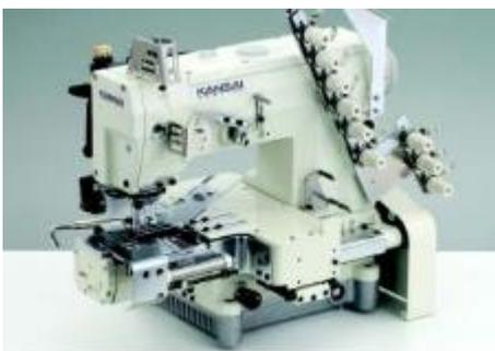
Пятиигольная машина с цилиндрической платформой (диаметр 340 мм) для втачивания резинки в пояс, с последовательно расположенными иглами, с механизмом горизонтального хода петлителя.
