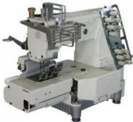
Шестиигольная машина двойного цепного стежка с цилиндрической платформой (диаметр 420 мм) для настрачивания «лампасов», с пуллером.
