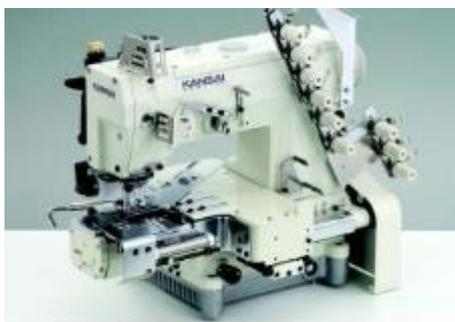
Пятиигольная машина с цилиндрической платформой (диаметр 340 мм) для втачивания резинки в пояс, с последовательно расположенными иглами, с механизмом горизонтального хода петлителя, с пневматической обрезкой нити и подъемом лапки, 4 петлителя, 9 нитей.
