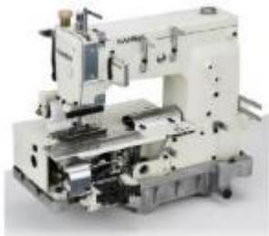
Четырехугольная машина двойного цепного стежка с плоской платформой, с задним пуллером для притачивания пояса джинсов.
