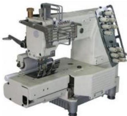
Шестиигольная машина двойного цепного стежка с цилиндрической платформой (диаметр 420 мм) для притачивания резинки, с пуллером, устройством дозированной подачи.
