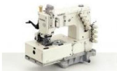
Двенадцатиигольная машина двойного цепного стежка с плоской платформой и задним гладким пуллером для выполнения поперечной складки. Машина позволяет шить эластичной ниткой, которая заправляется в петлитель. На машине установлен верхний раскладчик, который позволяет выполнять красивую декоративную строчку.
