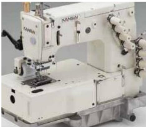
Четырехугольная машина двойного цепного стежка с плоской платформой, с задним гладким пуллером, для изготовления планки.
