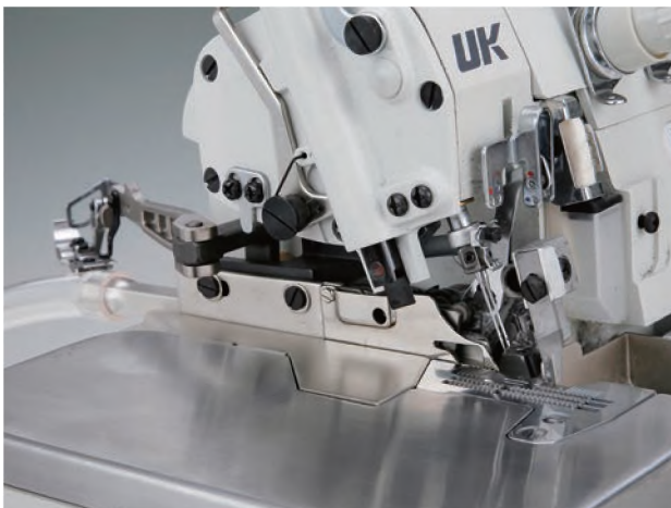
■ VTC ВЕРТИКАЛЬНАЯ ОБРЕЗКА ЦЕПОЧКИ НИТИ
