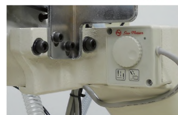
Цифровой шкив входит в комплект прямоприводного мотора
