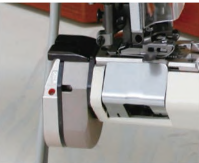
■ CS-2 Электрическая обрезка нити
